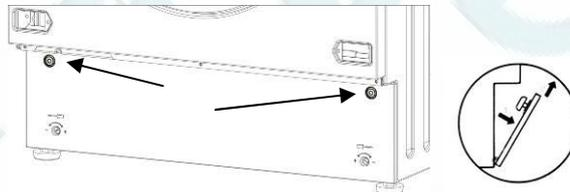
Отдельно стоящая модель - Вставьте маленькую отвертку в прорези в передней дверце плинтуса, затем слегка подденьте отверткой вверх, чтобы освободить верхнюю часть плинтуса корпуса. Слегка наклоните вперед плинтус и потяните его вверх, чтобы полностью снять.
