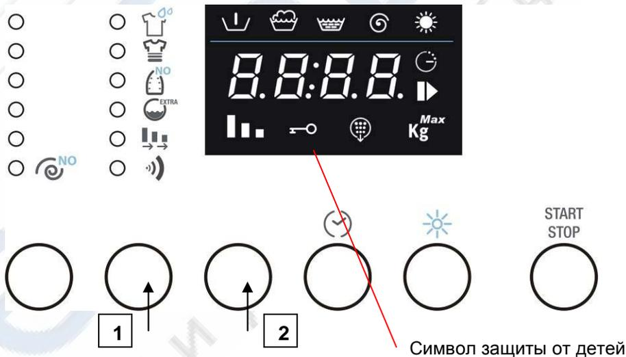
2. Для включения функции Защита от детей необходимо нажать и удерживать нажатой кнопку Выбор функций. В течение 3 секунд нажмите также кнопку Подтверждение дополнительных функций.
