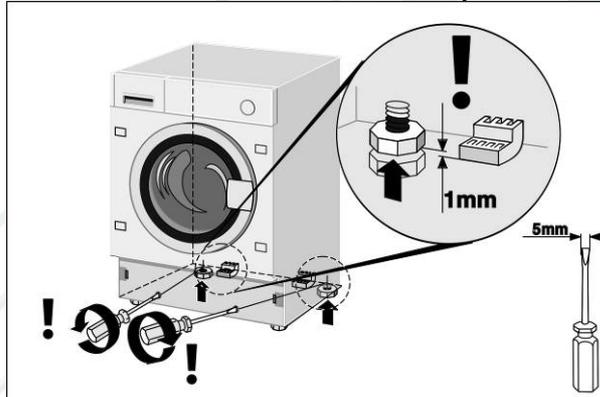
После установки машины в кухонную мебель необходимо поднять задние ножки, чтобы машина не опиралась о направляющие. После подъема задних ножек выполните выравнивание машины и крепление передних ножек.
